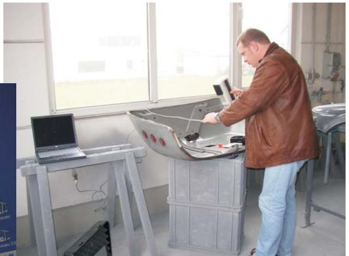
.....und danach steht die neu errechnete Farbmischformel im PC für den Lackierbetrieb zur Verfügung.
